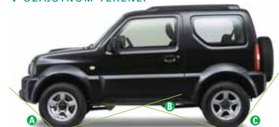
A 34° predný nájazdový uhol B 31° prejazdový uhol C 46° zadný nájazdový uhol
